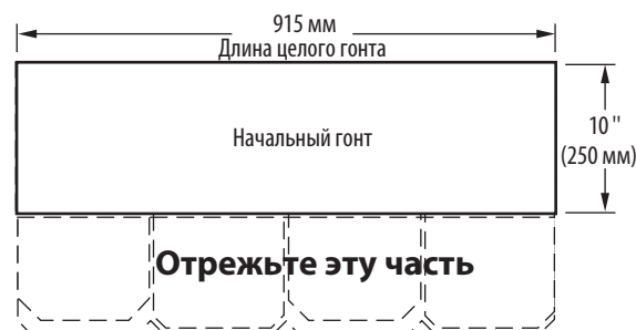
Рис. 16-7. Изготовьте гонты начального ряда, отрезав нижнюю часть высотой 20,3 см.
