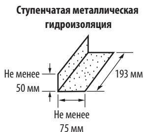
Рис. 12-10. Минимальные размеры ступенчато гидроизоляции.
