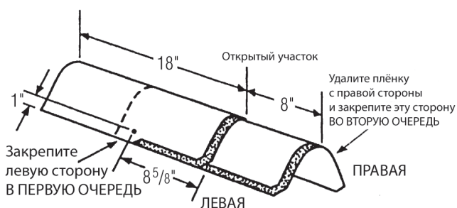
Рис. 16-19. Монтаж гонга Shangle® Ridge на рёбра и коньки.
