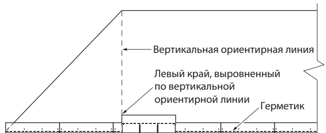
Рис. 9-2. Укладка первого гонта первого ряда таким образом, чтобы его левый край был выровнен по вертикальной ориентирной линии.
