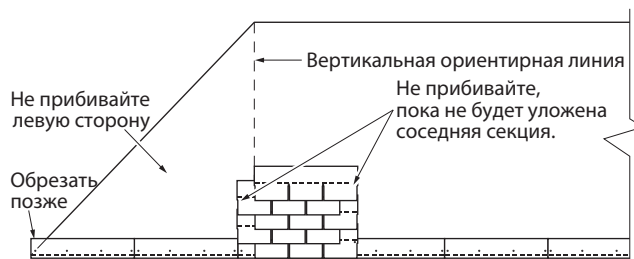
Рис. 9-5. Вертикальная секция гонта.
