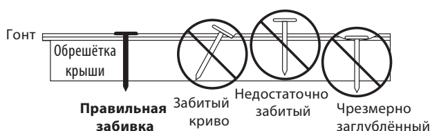
Рис. 15-5. Правильная и неправильная забивка гвоздей.
