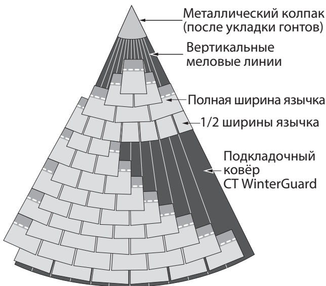
Рис. 9-6. Укладка гонта на округлённую часть крыши.
