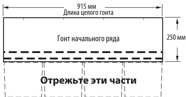
Рис. 14-10. Укладка гонтов начального ряда вдоль краёв ската.
