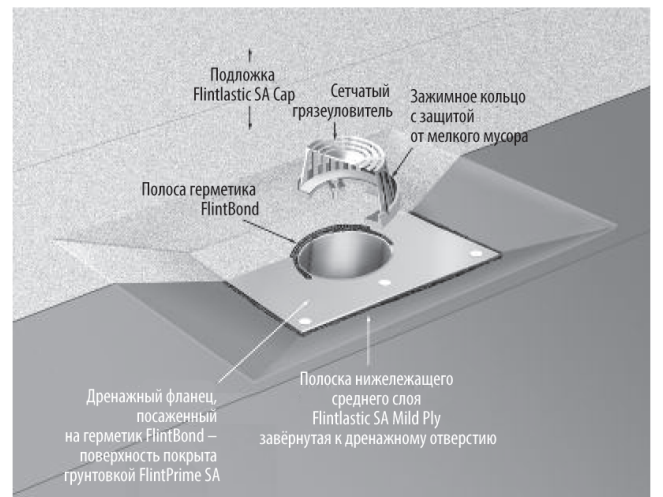
Рис. 5-36. Дренаж в трёхслойной системе.
