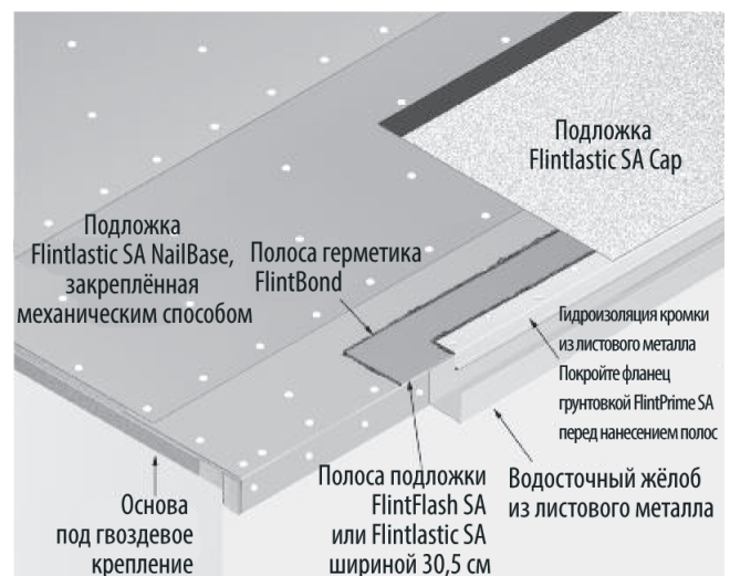
Рис. 5-30. Конструктивные особенности водосточного жёлоба в двухслойной системе.
