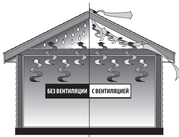
Рис. 7-8. Вентиляция чердачного помещения за счёт теплового эффекта.
