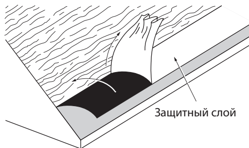
Рис. 5-6. Укладка методом «задираия и прижима».
